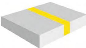
Bei geringer Belastung wählen Sie den stumpfen Stoß, bei größeren Belastungen vergrößern Sie die Klebestellen z. B. durch eine einseitige/zweiseitige Lasche, Überlappung oder Schäftung.
